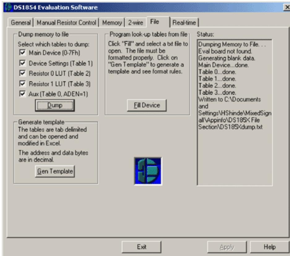
Figure 1. The File tab in the DS185XEVKIT software.
