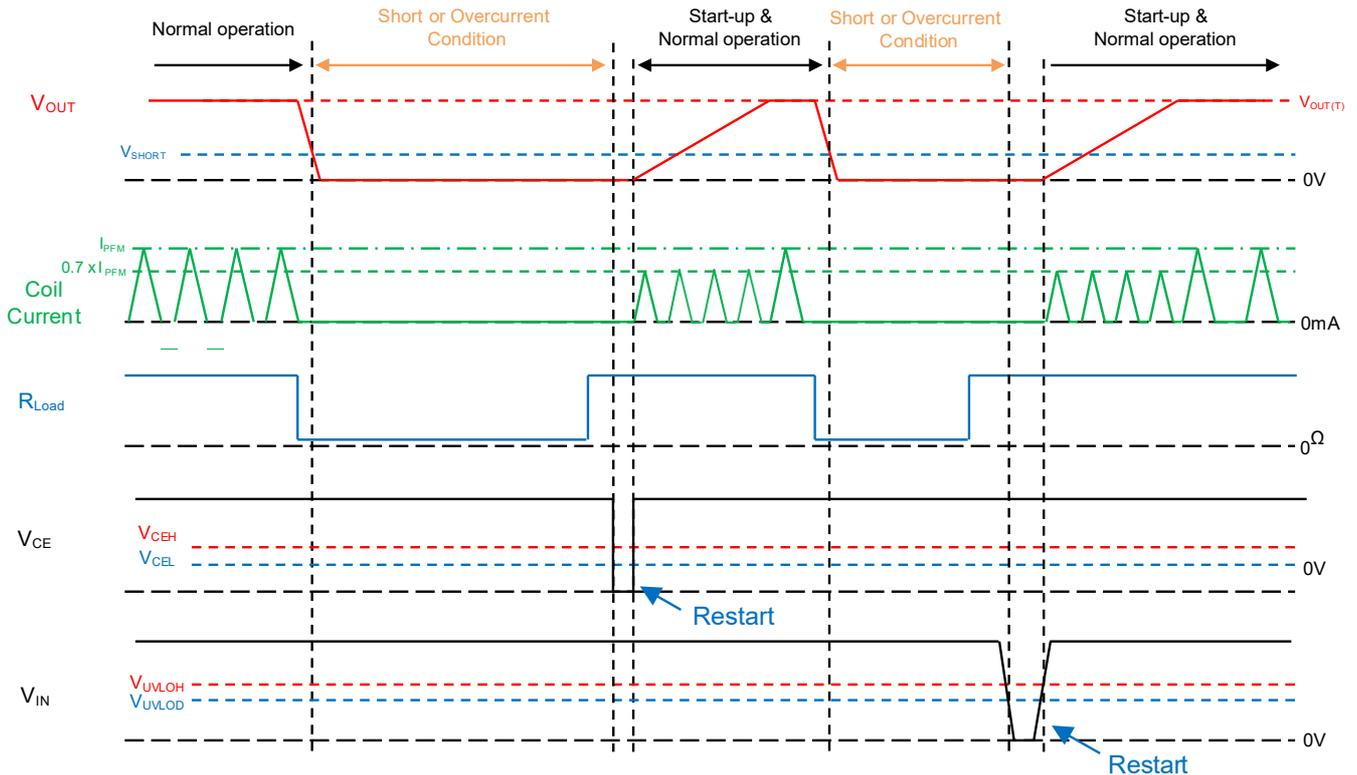
•Case (b) :  $V_{OUT} < 1.2V$
