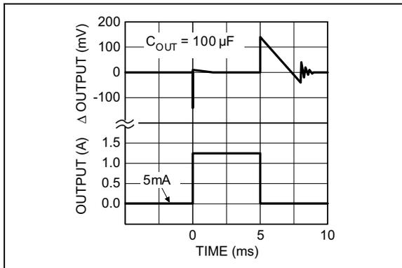
**FIGURE 2-15:** Load Transient.
