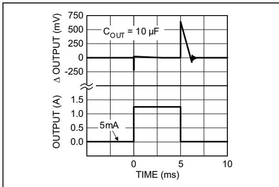
**FIGURE 2-14:** Load Transient.
