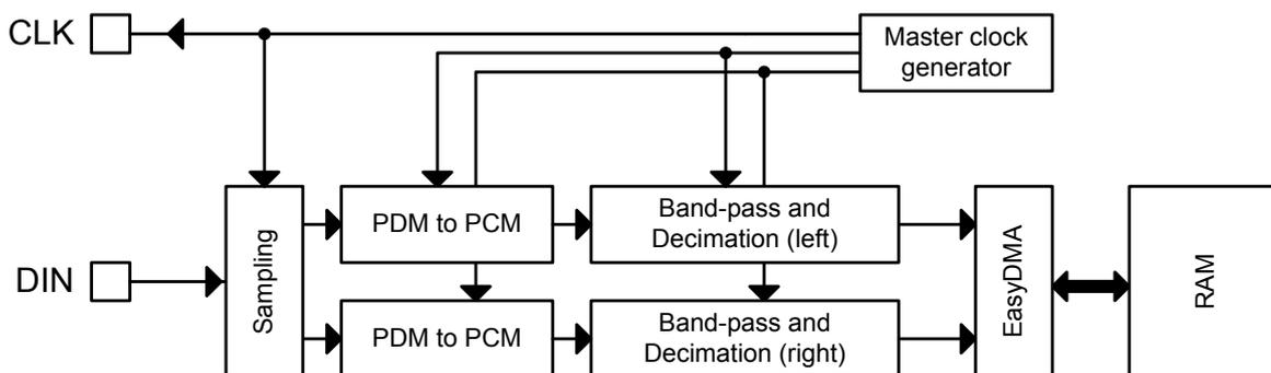
Figure 36: PDM module
