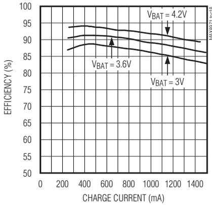
**BATTERY CHARGER EFFICIENCY vs. CHARGE CURRENT**
