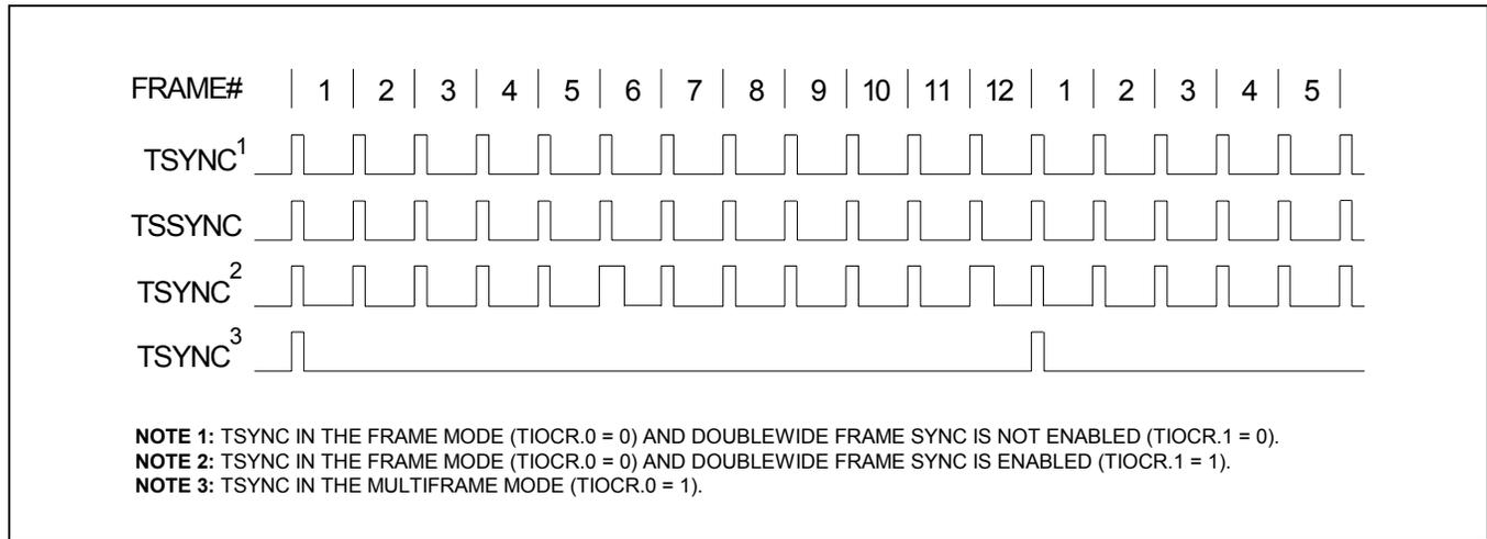
**Figure 13-9. T1 Transmit-Side ESF Timing**
